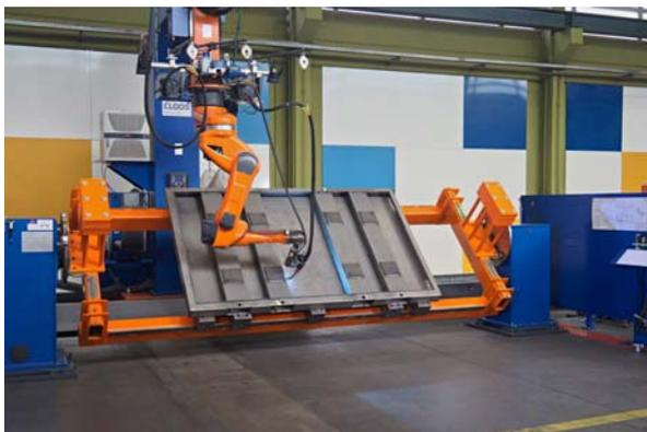
Der Dreh- und Schwenkpositionierer bewegt das komplexe Werkstück immer in eine für das Schweißen optimale Lage.
