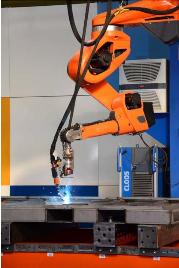
Die erhöhte Abschmelzleistung bei dem Cold Weld-Prozess resultiert in enormen Schweißgeschwindigkeiten bei dünnen Blechen
