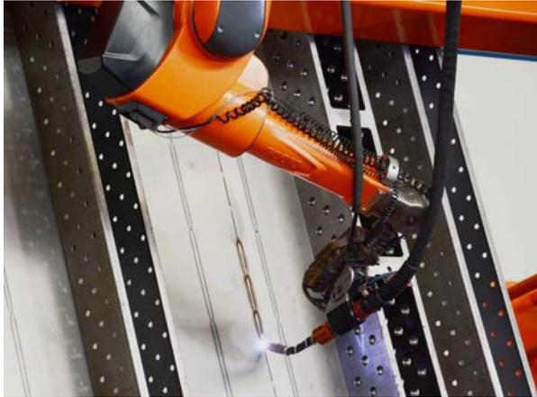
Der 7-achsige Roboter kann dank seiner hohen Reichweite einfach um Ecken oder in Nischen geführt werden.
