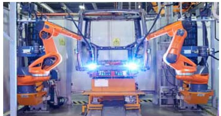
Nach dem Vorheften in den manuellen Stationen, verschweißen die 7-achsigen Roboter die Kabinen in den automatisierten Anlagen.
