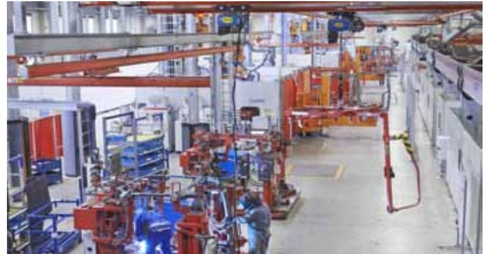
Die komplexe Fertigungslinie zum Verschweißen der Kabinen ist mehr als 70 Meter lang und besteht aus insgesamt zwölf Stationen..
