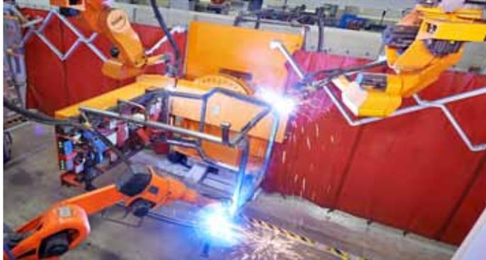
Die Werkstück-Positionierer, ausgestattet mit einer Wechsellvorrichtung, bringen die Kabinen in eine für das Schweißen immer optimale Lage..
