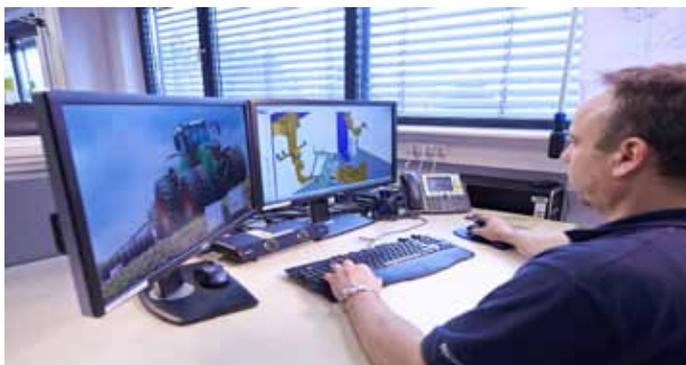
Die Offline-Programmierung mit der RoboPlan-Software von Cloos kann zeitgleich zur Produktion erfolgen: Ein enormer Zeitvorteil!
