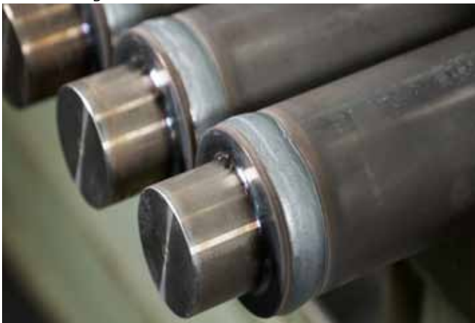
Bild 4: Durch den Einsatz des automatisierten Schweißens, konnte Albert-Frankenthal die Qualität der Walzen nochmals erheblich steigern.
