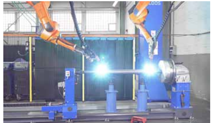
Bild 2: Die Roboter können je nach Bedarf entweder parallel Bauteile an beiden Stationen oder gemeinsam an einem Bauteil schweißen.
