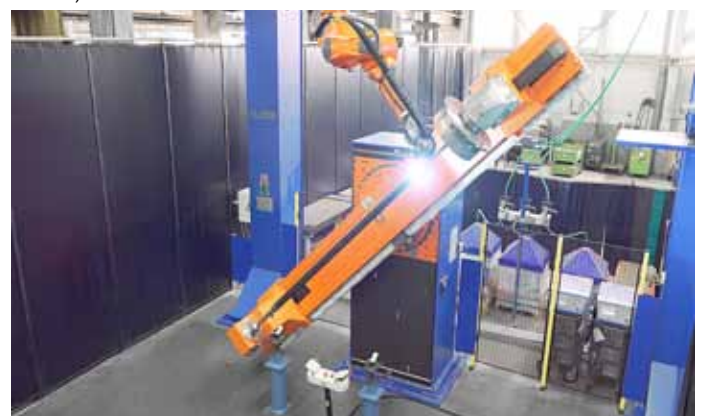
Bild 3: Die Werkstückpositionierer bringen die Walzen immer in die optimale Schweißposition
