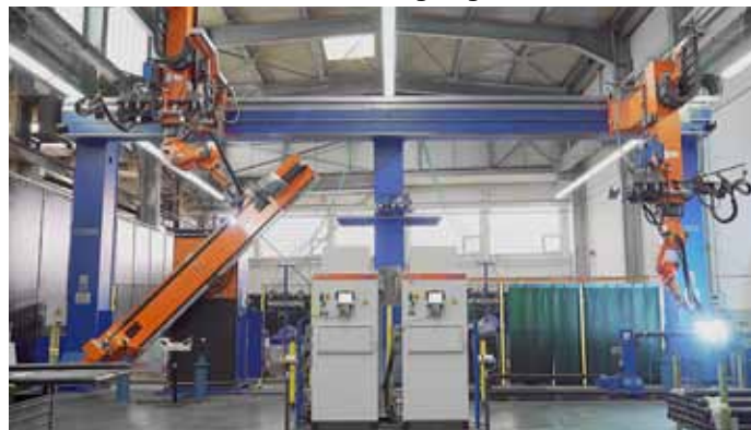
Bild 1: Die neue Roboteranlage besteht aus zwei Stationen, an denen parallel geschweißt werden kann.
