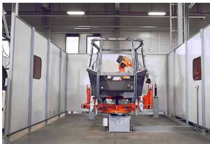
Bild : Nach dem Schweißprozess prüft ein QIROX-Roboter von CLOOS die Qualität der gefertigten Traktorkabinen.
