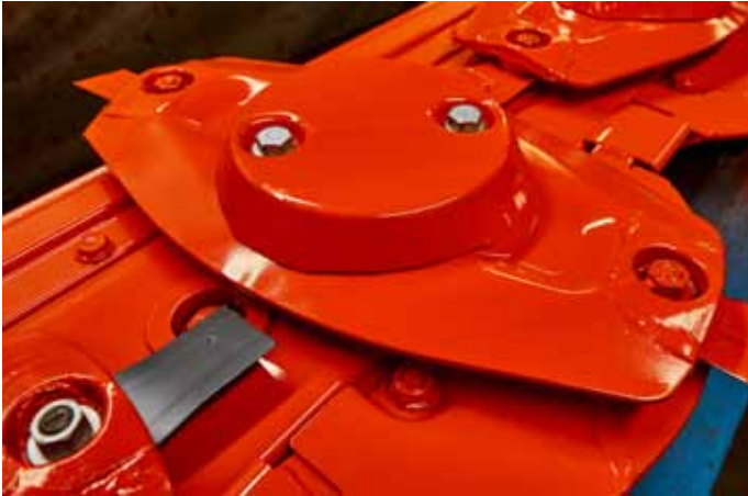
Bild 4: Der QIROX QRH-280 schweißt unter anderem Scheiben für Mähmaschinen.
