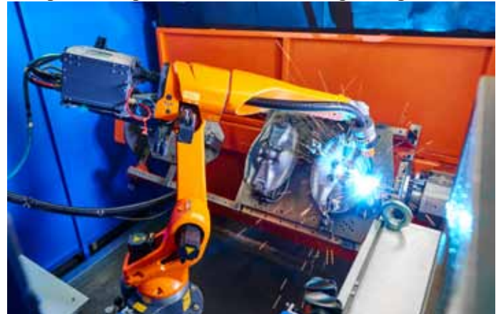
Bild 2: Der kompakte Schweißroboter QIROX QRH-280 agiert besonders schnell und hochdynamisch.
