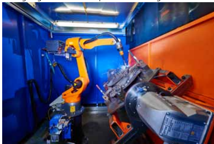
Bild 1: Mit der neuen Schweißzelle konnte Kuhn die Taktzeiten beim Schweißen von Kleinteilen für Landmaschinen um 15 Prozent reduzieren
