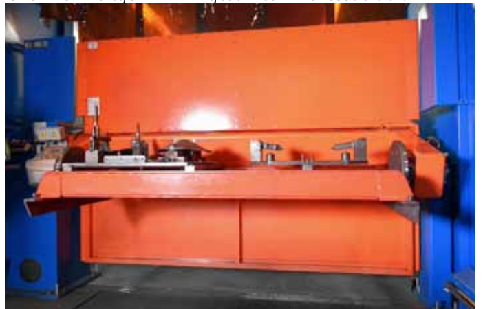
Bild 3: Der 2-Stationen-Positionierer bringt die Werkstücke immer in die optimale Schweißposition
