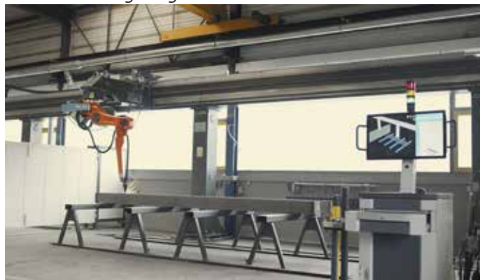
Bild 1: Mit der neuen Roboteranlage werden unterschiedliche Bauteile für den Stahl- und Metallbau geschweißt.
